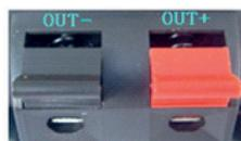
Кабельді қысқыш-клеммалардың қызыл (+), қара (-) көмегімен шығаратын сигнал үшін арналған сәйкес клеммаларға қосыңыз.
